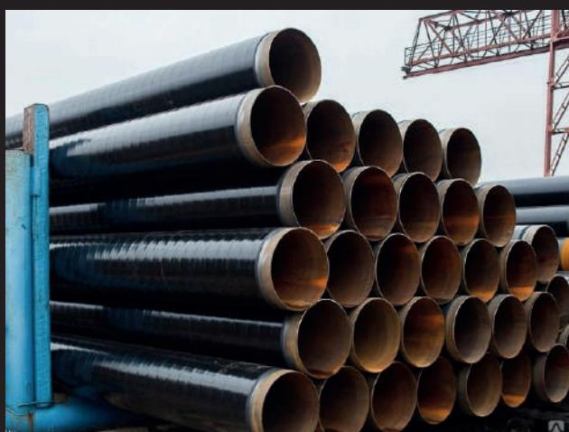
Битумная гидроизоляция труб — применяется для изоляции магистральных нефтегазовых и водопроводчиков с температурой транспортировочной среды до плюс 40 °С. Основная функция битумной изоляции — это антакоррозионная защита (изолированные трубы устойчивы к влажности, температурным перепадам, агрессивным средам), гидроизолированная труба имеет высокие прочностные характеристики, устойчивость к механическим повреждениям, широкий диапазон
