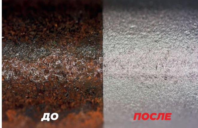
Покрытие, которое будет нанесено после применения технологии пескоструйной обработки металла, будет служить долго и качественно. Это объясняется тем, что поверхность металла проходит глубокую степень очистки, улучшая сцепление лакокрасочного покрытия с изделием.
